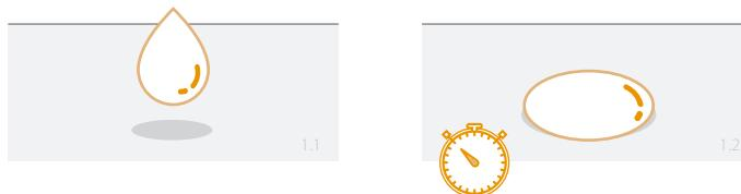
**Résultat :** Absorbée entre 60 et 240 sec. On dit alors que le support est normalement absorbant.
