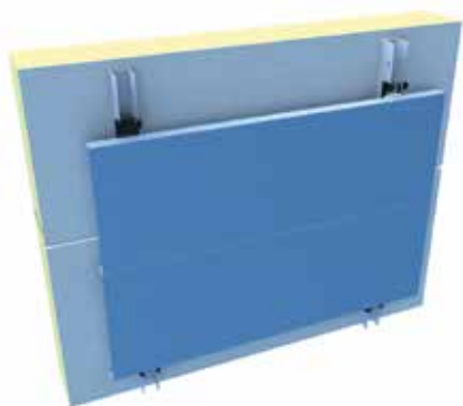
Hybrid FC Paneel auf Sandwichelement: horizontal, parallel
