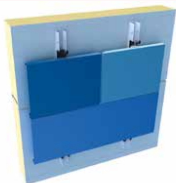
Panneau Hybrid FC sur élément sandwich: pose horizontale, en quin-conce
