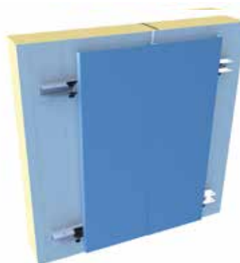
Panneau Hybrid FC sur élément sandwich: pose verticale, parallèle
